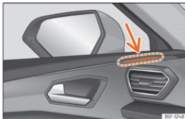
Fig. 197 Door: warning lamp
