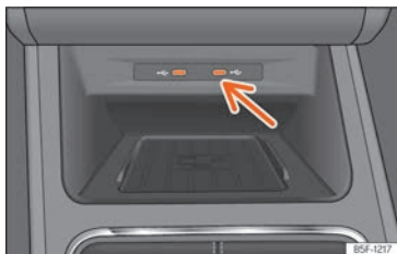
Fig. 161 Centre console: USB port.
