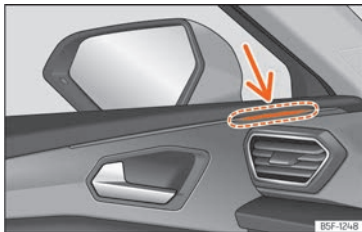
Fig. 195 Door: warning lamp
